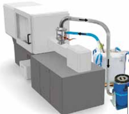
Anwendungsbeispiel HELIOJET 2M mit Entstaubung direkt auf einer Spritzgießmaschine
