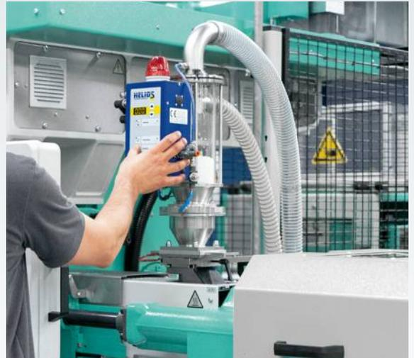
HELIO®Clean Entstaubungsgeräte können aufgrund ihrer kompakten Bauweise direkt auf die Spritzeinheit oder einen Trockenbehälter montiert werden.
