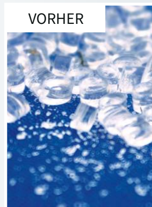
PMMA Rohgranulat vor und nach dem Entstauben.
